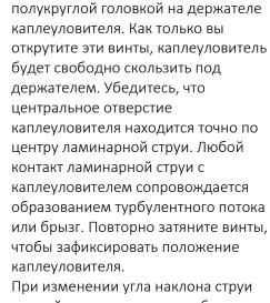
Регулировка каплеуловителя Ослабьте винты с торцевой
