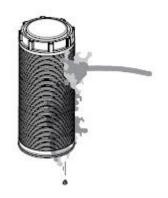
Промойте сетку под давлением до тех пор, пока не удалите все загрязнения. Установите сетку обратно в предфильтр и плотно завинтите крышку, чтобы не допустить утечку или ухудшение потока.
