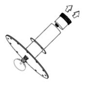
Отсоедините кабельный ввод на задней стороне и извлеките резиновое уплотнение. Извлеките светодиодный светильник рукой, без использования специальных инструментов. В противном случае можно повредить уплотнение светильника.
