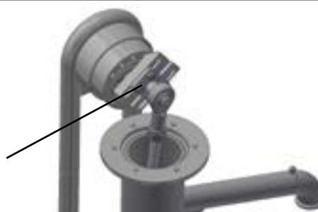
Ослабьте 4 зажимные гайки (M8 - размер ключа 13 мм) на эксцентриковом суппорте на 1-2 оборота.
