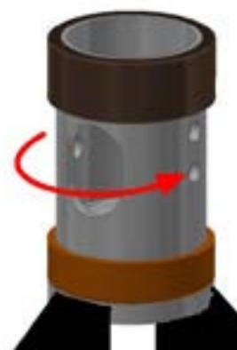
4. Вставьте подходящую трубку или шпindel в овальные отверстия верхней части поршня для использования в качестве рычага. При повороте верхней части поршня с рычагом против часовой стрелки (правосторонняя резьба) верх поршня снимется с нижней части.
