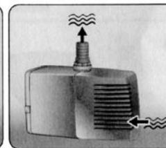
Схема сухого монтажа:
