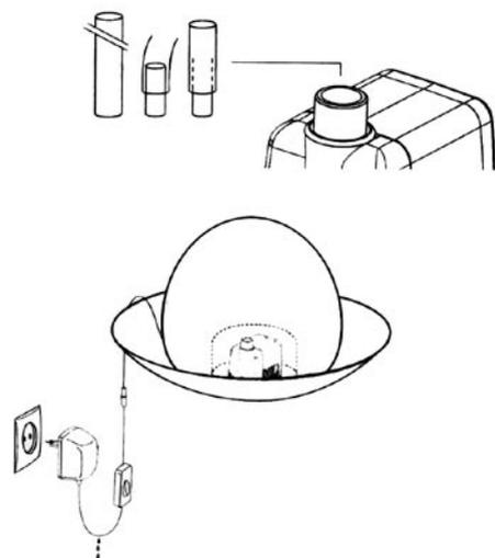
Необходимо регулярно очищать фильтр насоса. Для этого нужно отсоединить адаптер от электросети, снять переднюю панель насоса и промыть его под теплой водой.
