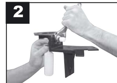
2 Затяните крепежный болт поплавкового клапана так, чтобы клапан находился под углом в 90° к крышке. Затяните белый болт, чтобы закрепить положение поплавка.
