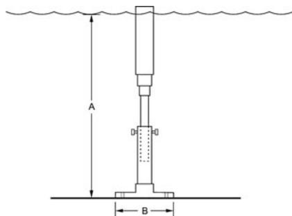
Габариты: высота 350-500 мм (регулируемая), диаметр 135 мм.
