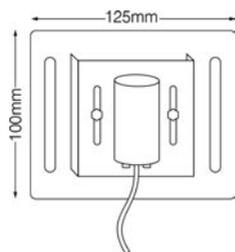
Габариты: высота 100 мм, ширина 125 мм.
